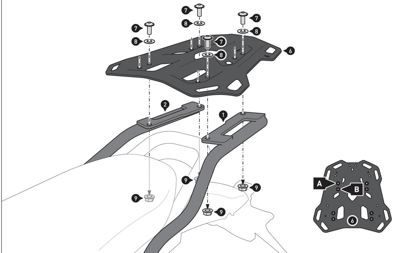
**⚠ NOTA:** Atornille el portaequipaje en la posición de montaje marcada (A) o (B), según el espacio disponible, como se muestra en el dibujo de detalle.
